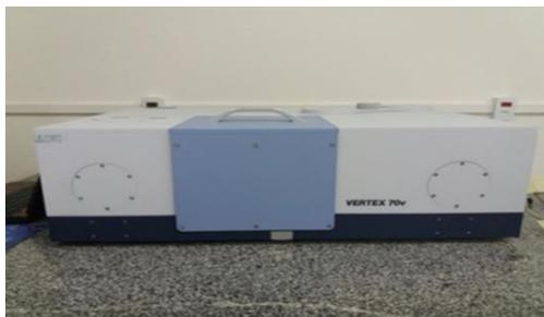
**Figura 12** - Espectrômetro Vertex 70v da Bruker. (Laboratório de Espectroscopia Ótica e Fototérmica II- (LEOF II) - UFMA).
