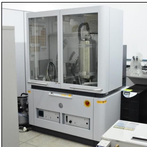
**Figura 10** – Difratômetro Modelo *Empyrean* da *PANalitical*. Laboratório de Difração de Raios X – LDRX - PPGCM/UFMA.
