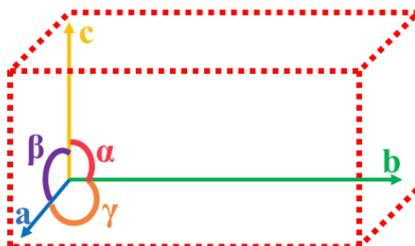
**Figura 51** - Célula Unitária e parâmetros de rede. **Fonte:** Adaptado de Cullity e Stock (2014) [162].
