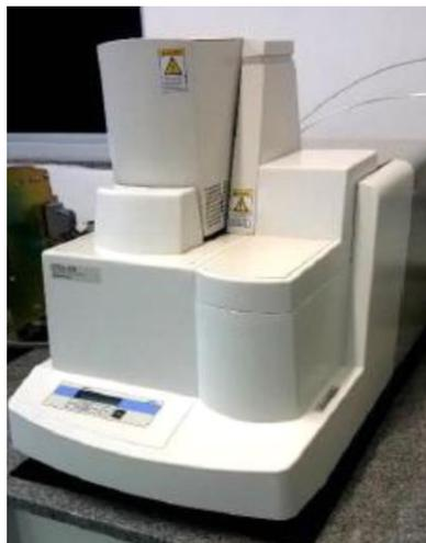
**Figura 14** - Analisador térmico DTG-60 da *Shimadzu Instruments*. (Laboratório de Análise Térmica- (LAT) - PPGCM/UFMA).
