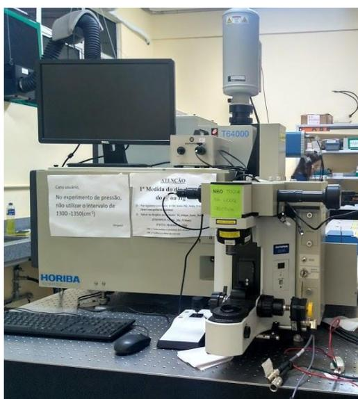
**Figura 11** - Espectrômetro *Horiba Jobin Yvon Triplemate 64000* (Laboratório de Espectroscopia Vibracional - UFPA).
