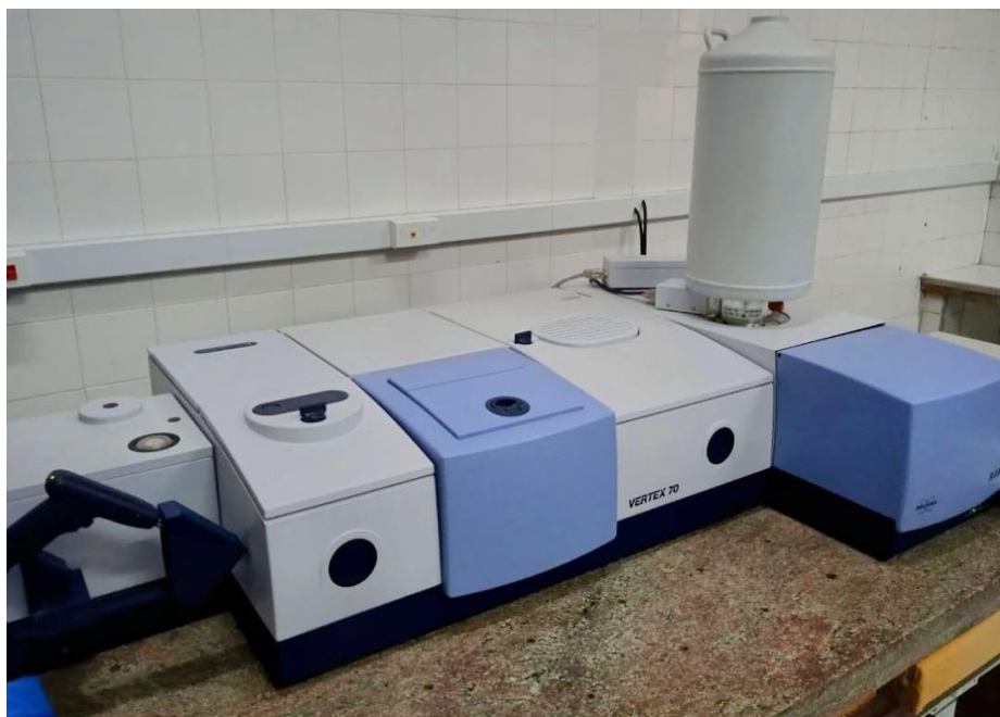
Figura 19. Imagem do espectrômetro infravermelho por transformada de Fourier Vertex 70v utilizado para obter espectro de FT-IR.
