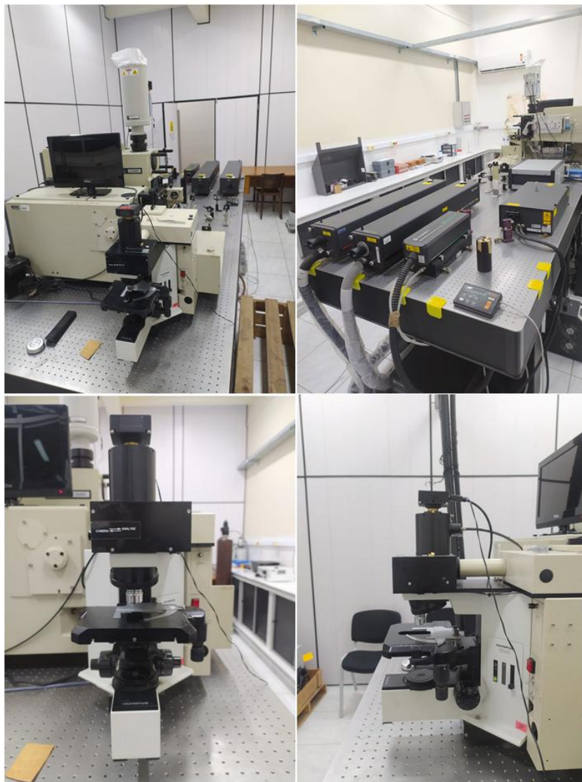
Figura 15. Imagem do equipamento espectrômetro Horiba-Jobin Yvon T64000 equipado com um microscópio Olympus e um LN2-cooled CCD utilizado para obtenção dos espectros Raman ambiente e dependentes do gradiente de temperatura e pressão do \text{Fe}_2\text{WO}_6 .
