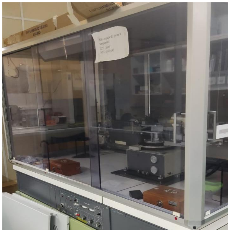
Figura 14. Imagem do equipamento Rigaku D/MAX-B utilizado para difratometria de raios X do material policristalino Fe_2WO_6 .
