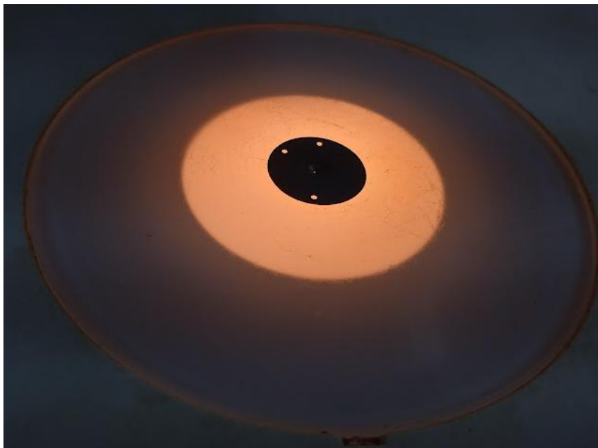
Figura 17. Imagem de uma gaxeta através de um microscópio, no qual é possível observar o orifício onde ficam o material e o rubi submersos em um líquido transmissor de pressão.
