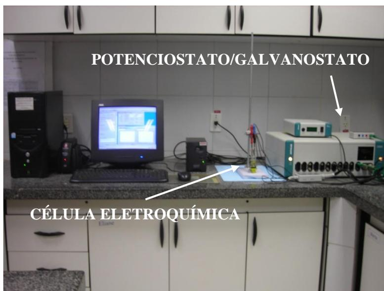
**Figura 10** - Arranjo do Potenciostato/Galvanostato AUTOLAB (Eco Chemie), Mod PGSTAT30, conjugado a um analisador de frequência, FRA 4.9 utilizado nos testes de espectroscopia de impedância eletroquímica.
