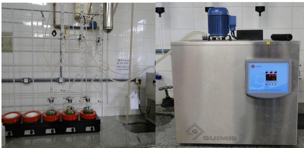
Figura 5. Extrator de Clevenger acoplado a sistema de refrigeração
