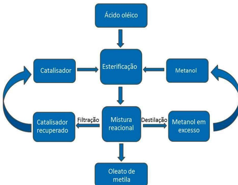
Figura 6 - Processo de esterificação do ácido oléico utilizando os catalisadores CB5N7 e CC5N7.
