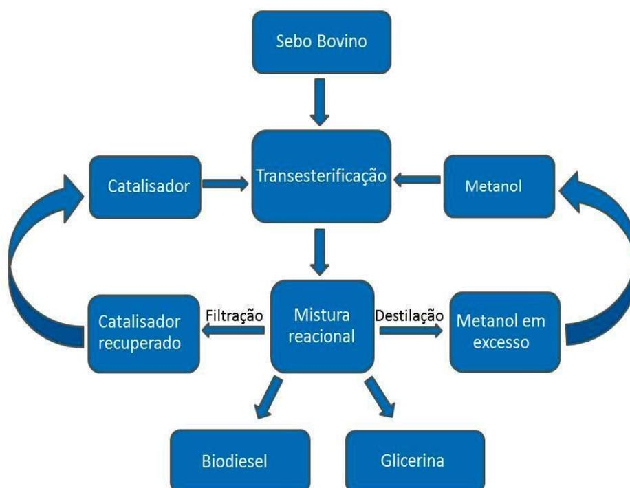
Figura 7 - Processo de transesterificação do sebo bovino.
