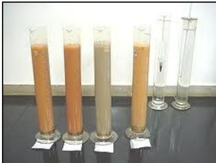
Figura 11: Determinação da granulometria pelo método da pipetagem.
