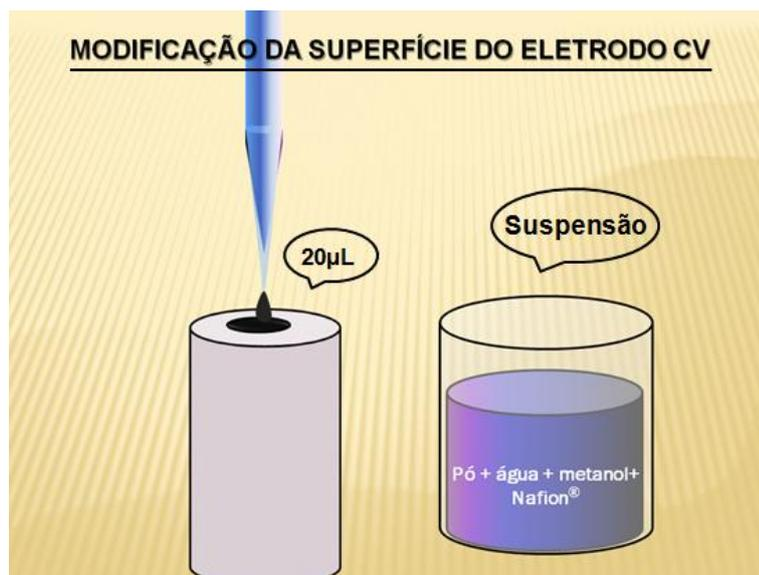
**FIGURA 4:** Esquema do preparo do eletrodo de trabalho
