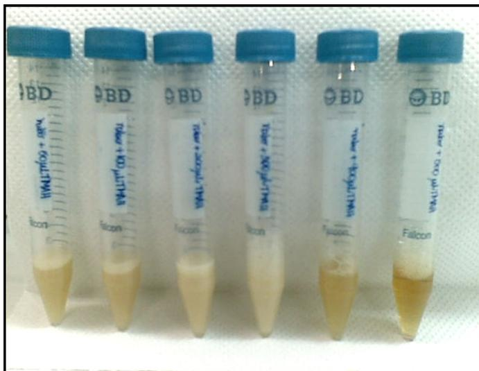
**Figura 7.** Volumes de TMAH adicionados às amostras de biodiesel de nabo forrageiro. Da esquerda para a direita: 50, 100, 200, 300, 400 e 500 µL de TMAH.
