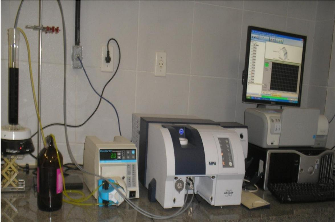
**Figura 4:** Sistema utilizado para se determinar o início de precipitação por infravermelho próximo.
