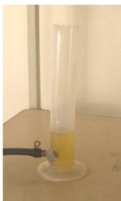
Figura 4.3: Esquema usado para medida do consumo de combustível.
