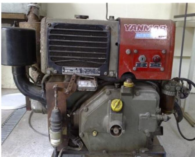
Figura 4.2: Motor do ciclo diesel (YANMAR) usado na avaliação do consumo, vazão e emissões gasosas.
