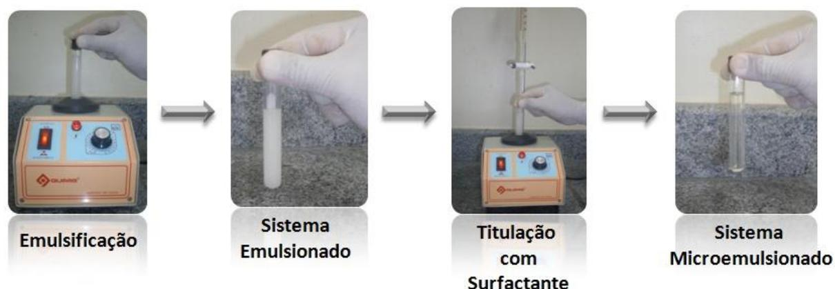
Figura 4.1. Procedimento de obtenção do sistema microemulsionado.
