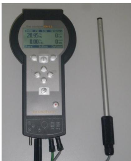
Figura 4.6: Analisador de gases com sonda de medida de concentração volumétrica dos gases  $O_2$ ,  $CO$ ,  $CO_2$  e  $NO_x$ .
