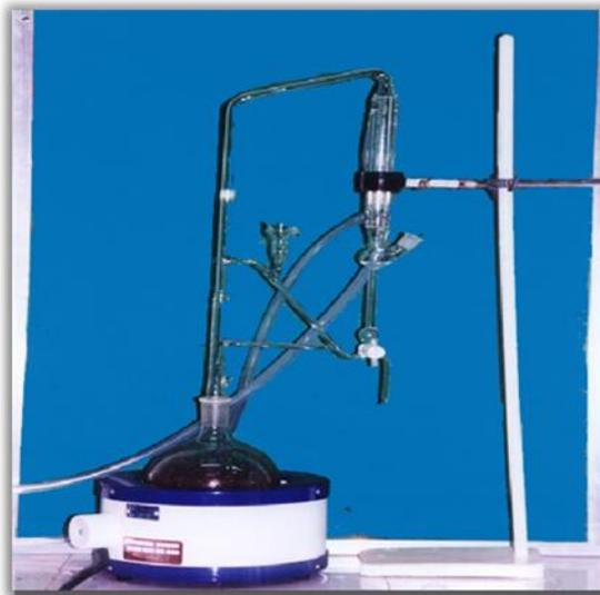
Figura 8 – Sistema Extrator de Clevenger
