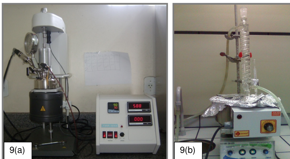
Figura 9 - Equipamentos para reação de eterificação: (a) Reator de alta pressão, (b) Balão de vidro com sistema de refluxo, agitação magnética e aquecimento em banho-maria
