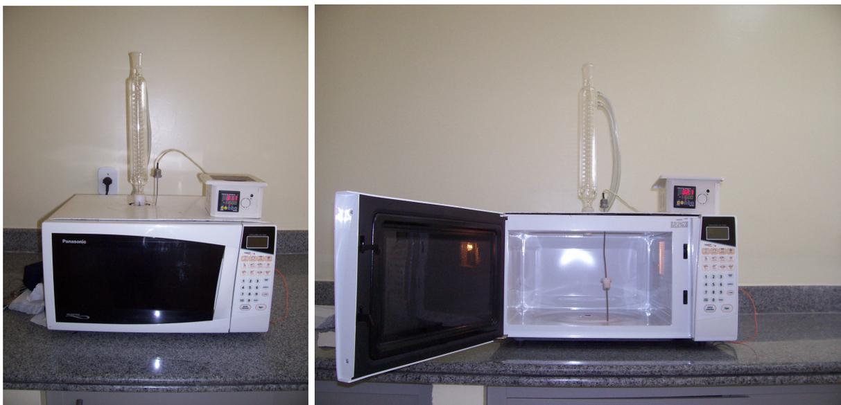
**Figura 7** – Forno de microondas adaptado
