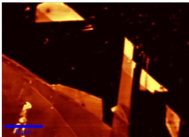
*Figura 3.6. Imagens do espalhamento Raman referentes aos modos G' (2674 cm<sup>-1</sup>). Área varrida: 30 × 40 μm<sup>2</sup>. Espectros por imagem: 62500.*
