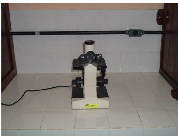
**Figura 3.4** - Microscópio metalográfico utilizado no controle de qualidade dos ataques.
