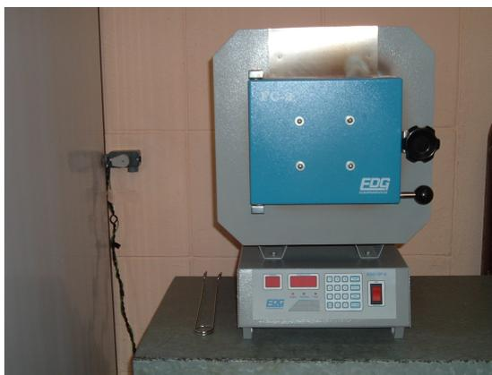
**Figura 3.2** - Forno tipo mufla utilizado nos tratamentos térmicos das amostras.
