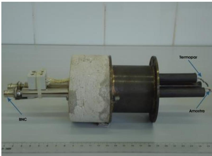
Figura 18 – Parte anterior do porta-amostras mostrando no detalhe os fios de níquel-cromo, o termopar, o local da amostra e as conexões BNC.
