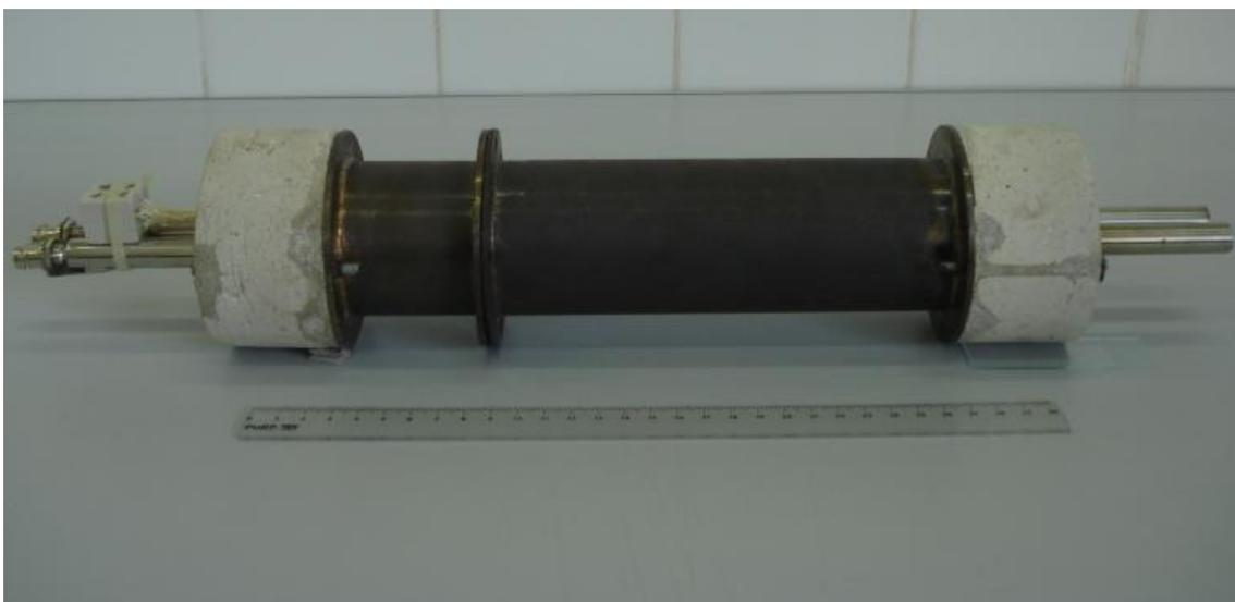
Figura 19 – Porta-amostras completo. Depois de soldada a amostra com tinta prata coloidal, a parte posterior do aparato é encaixada na anterior por meio de parafusos e porcas.
