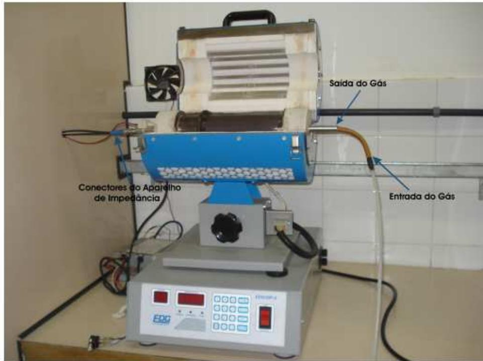
Figura 3-2. Forno EDG10P -S, utilizado para variar a temperatura da amostra.
