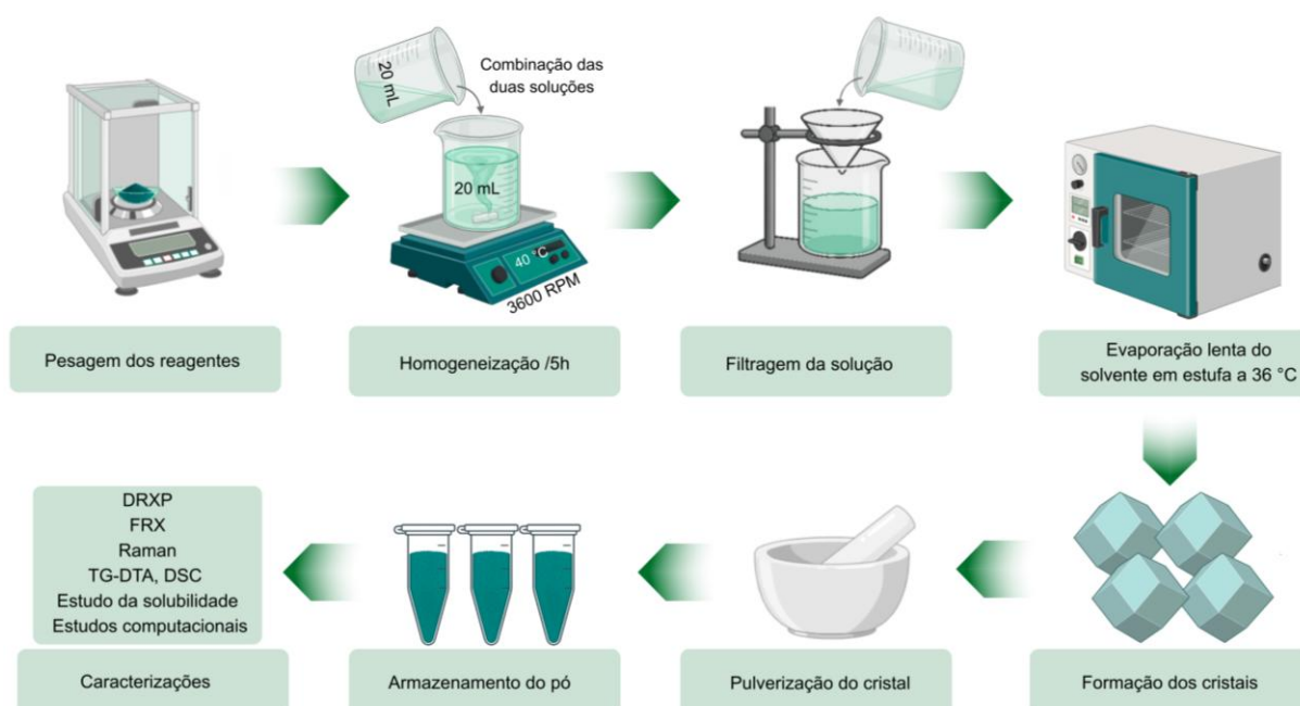
Figura 16. Processo de síntese dos cristais utilizando o método de evaporação lenta do solvente.
