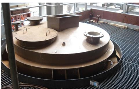
Figura 22 – Demonstração de Equipamento do Sistema de Alimentação de Areia (Silo de Armazenamento).
