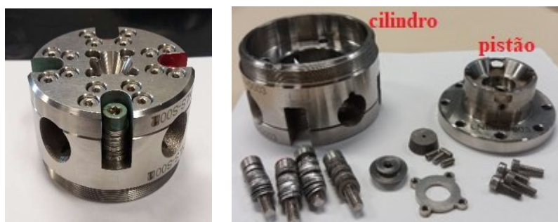
Figura 3.9 – Célula de bigorna de diamante (DAC, do inglês Diamond Anvil Cell ) convencional fechada (esquerda) e com todas as suas partes de montagem (direita): cilindro, pistão, quatro parafusos que fecham a célula, bases de fixação do diamante (seat e rocker) e respectivos parafusos de fixação das bases.
