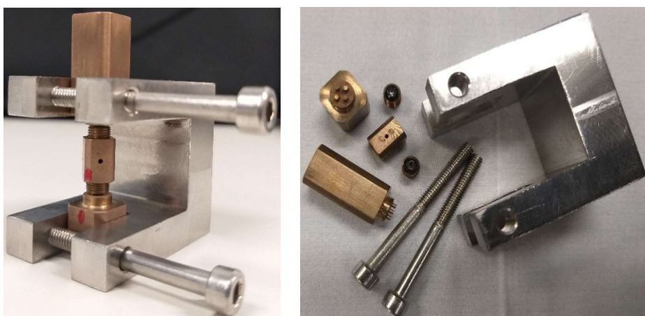
Figura 3.17 – SQUID-DAC fechada no suporte (esquerda) e com todas as suas partes de montagem (direita): corpo, parafusos, bases e suporte que prende a célula, com auxílio de 2 parafusos, para aplicação de pressão.
