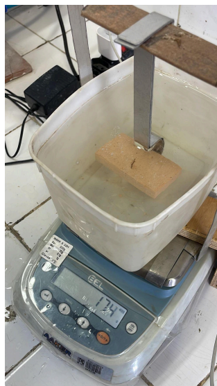
FIGURA 22: CP em balança hidrostática
