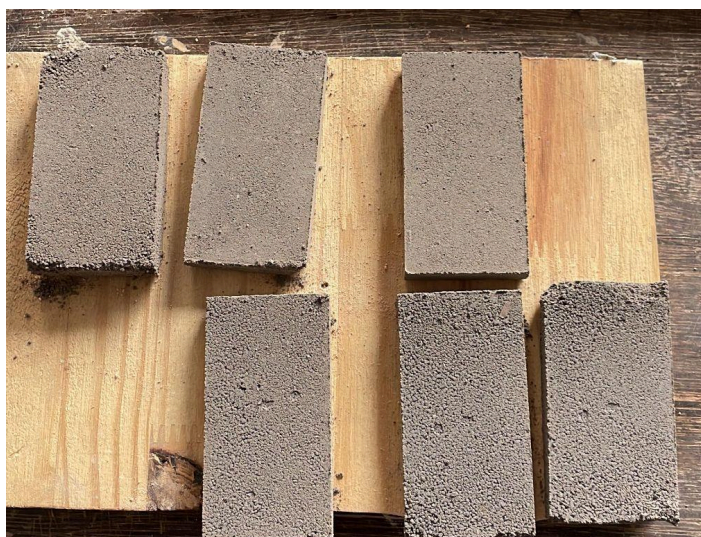
FIGURA 28: Corpo de prova compactado no molde
