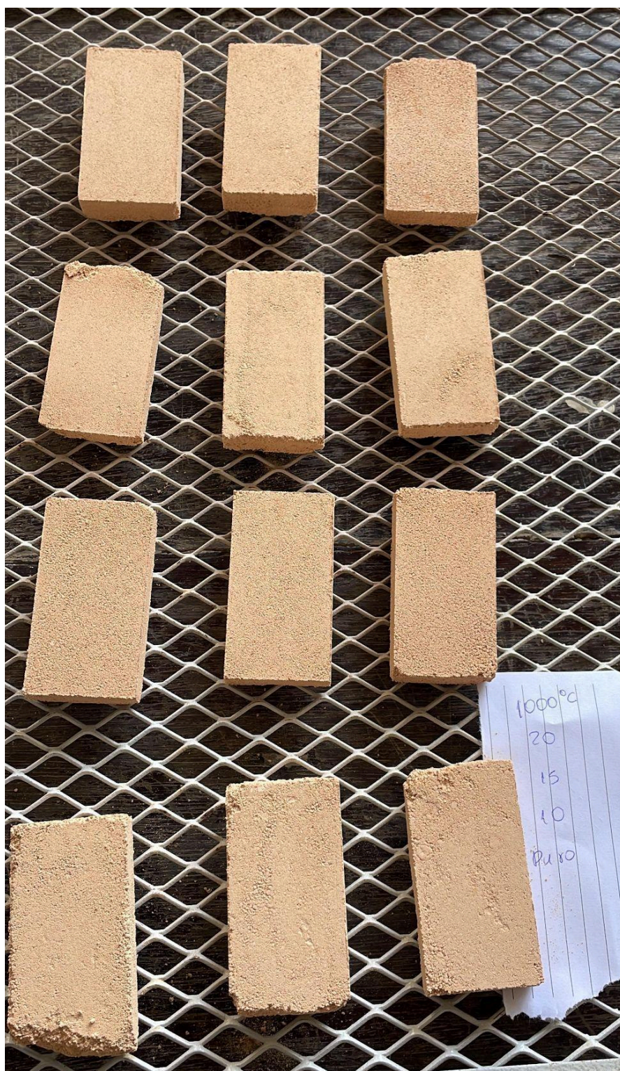
FIGURA 29: Corpo de prova compactado no molde e queimado.
