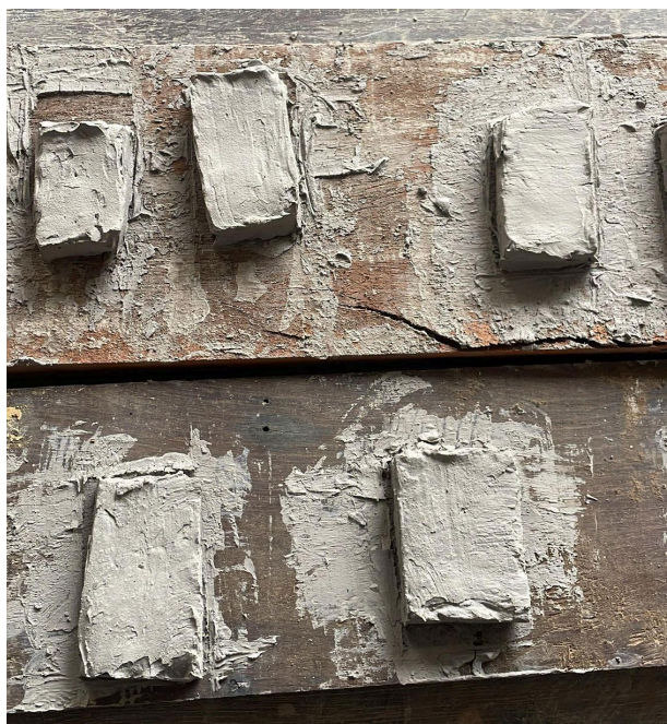
FIGURA 35: CP após 24h na estufa a 60°C
