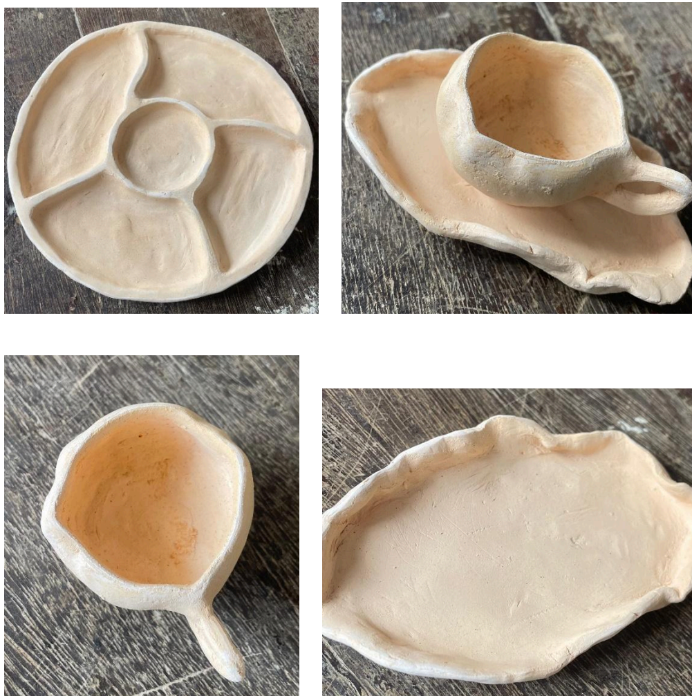
FIGURA 41: Peças após a queima a 1000°C
