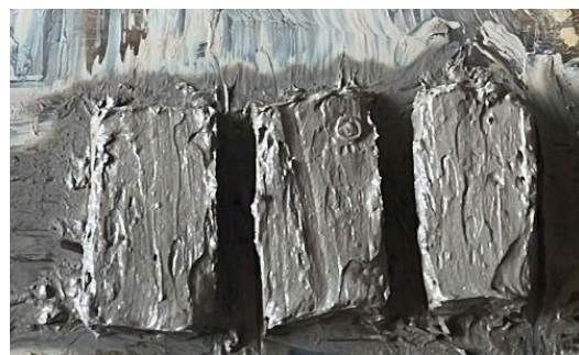
FIGURA 19: Corpo de prova no processo de secagem
