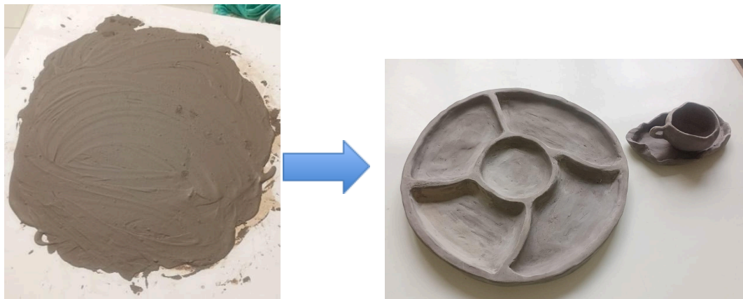
FIGURA 40: Modelagem à mão livre sobre forma de gesso
