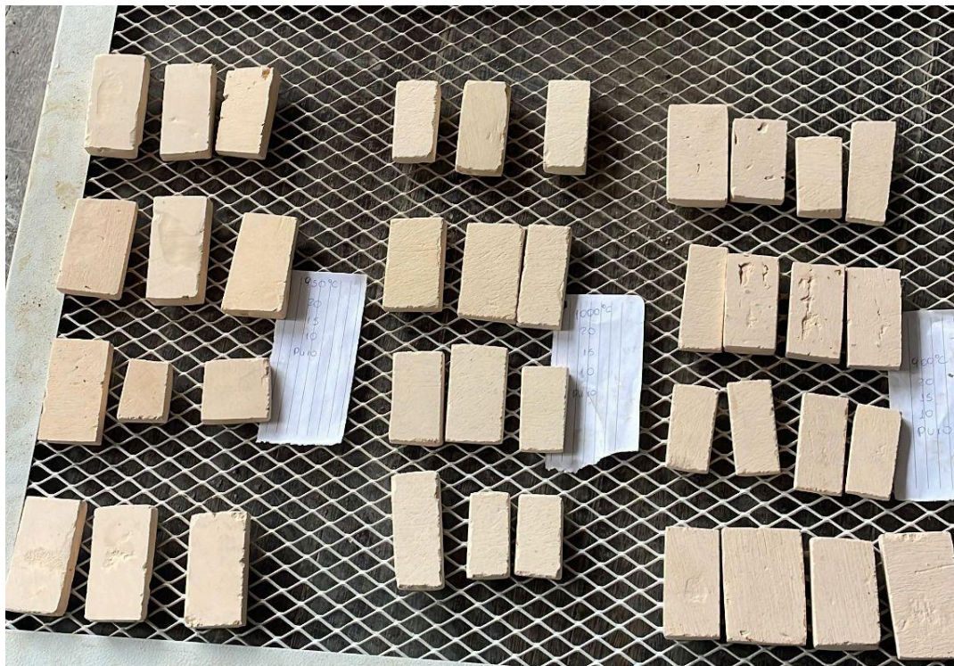
FIGURA 38: CPs queimados a esquerda para a direita 950°C, 1000°C e 900°C
