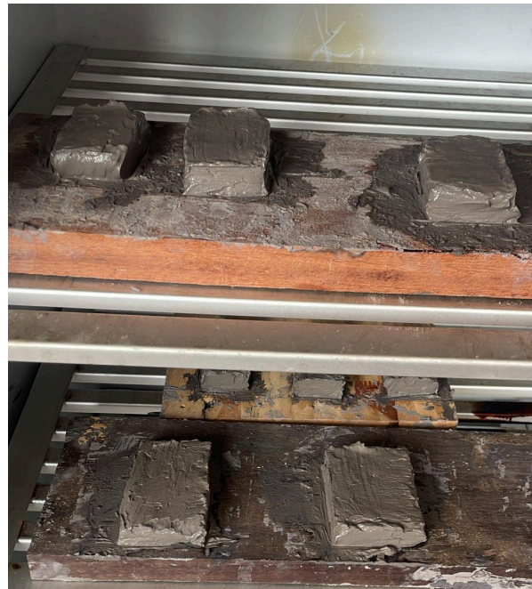
FIGURA 34: CP na estufa a 60°C imediatamente após modelagem
