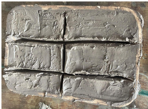
FIGURA 33: Corpo de prova no isopor durante a secagem
