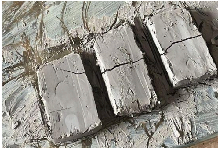
FIGURA 32: Corpos de prova sem resíduos fissurados ao décimo dia
