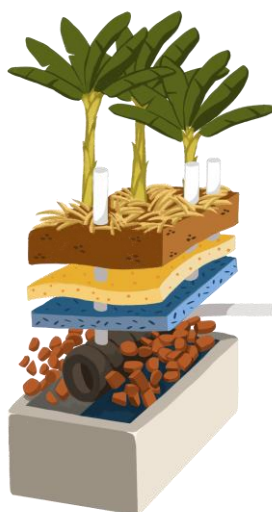
Figura 3 - Ilustração da estrutura e camadas do TEVAP.
