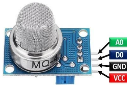
Figura 7 - Sensor MQ-4 montado em PCI
