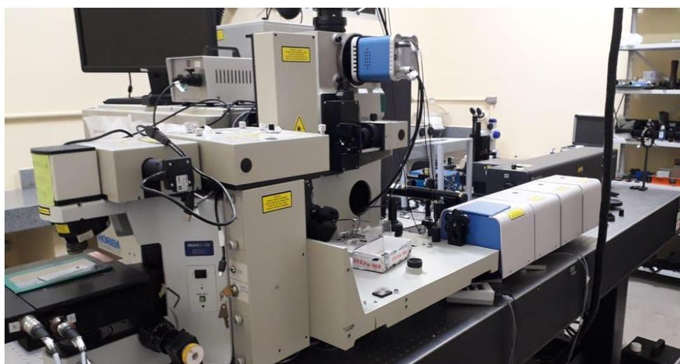
**Figura 11:** Espectrômetro da *Horiba Jobin Yvon* modelo *T64000* usado para obter espectros Raman em diversas condições termodinâmicas
