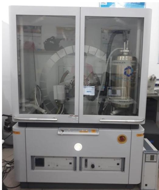
**Figura 10:** Difratorômetro de raios X da marca *PANalytical* modelo *Empyrean*.
