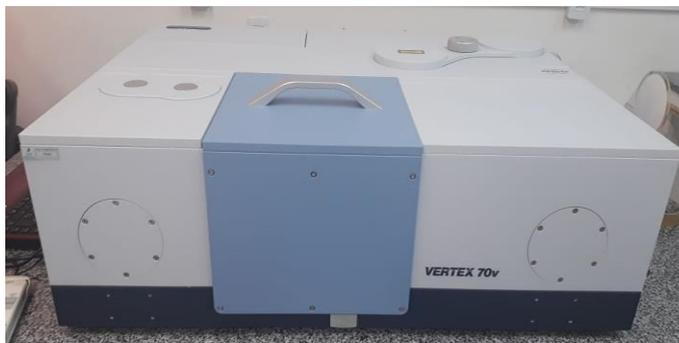
**Figura 12:** Espectrômetro da marca Bruker modelo Vertex 70V usado para medir espectros de absorção no região do infravermelho.
