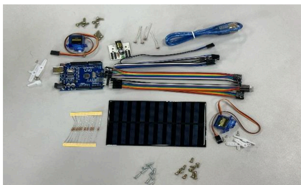
Figura 9 – Disposição completa do kit com Arduino Uno, servomotores, sensores LDR e painel solar
