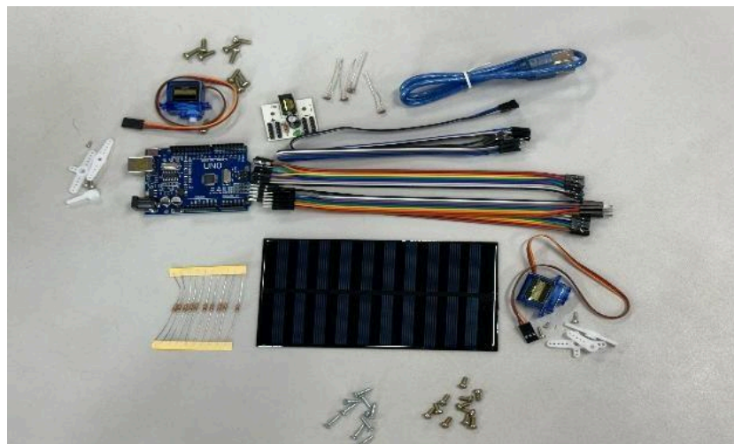
Figura 5 – Disposição completa do kit com Arduino Uno, servomotores, sensores LDR e painel solar
