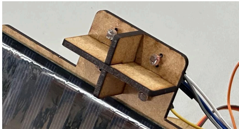
Figura 8 – Funcionamento das abas sombreadoras sobre os sensores LDR
