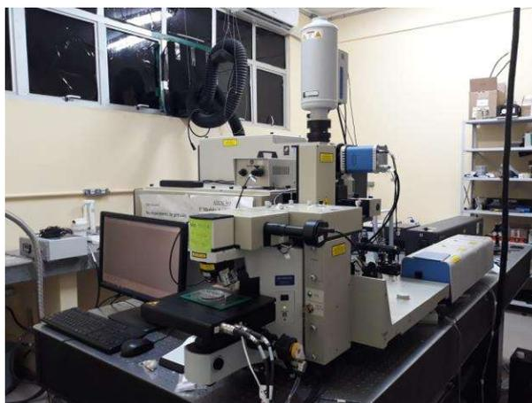
Figura 11 – Fotografia do espectrômetro Raman marca *Jobin-Yvon* modelo *T64000*
