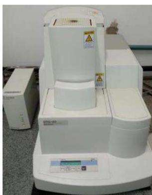
Figura 13 – Fotografia do analisador térmico (TG/DTA) marca *Shimadzu* modelo *DTG-60*.
