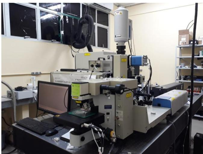
**Figura 15.** Espectrômetro Raman marca Jobin-Yvon modelo T64000.
