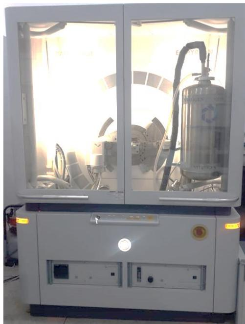
**Figura 11.** Difratorômetro de raios X, modelo *Empyrean* da marca *PANalytical*.
