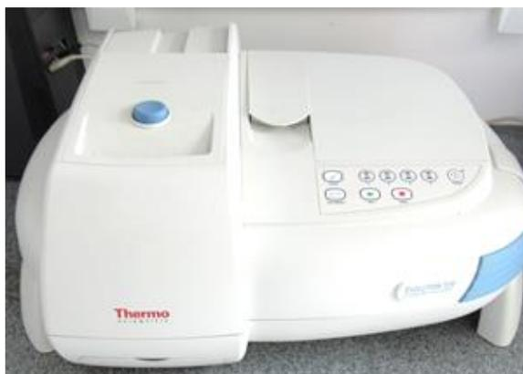
**Figura 12.** Espectrofotômetro UV-vis, modelo *Evolution220* da marca *Thermo Scientific*.
