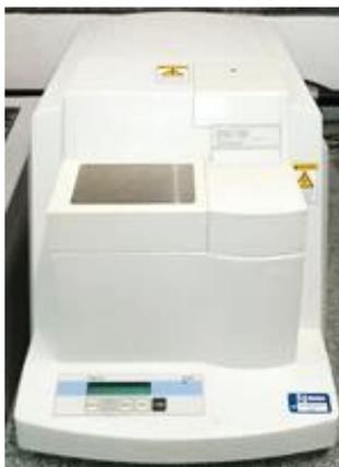
**Figura 13.** Analisador calorimétrico, modelo *DSC 60* da marca *Shimadzu*.
