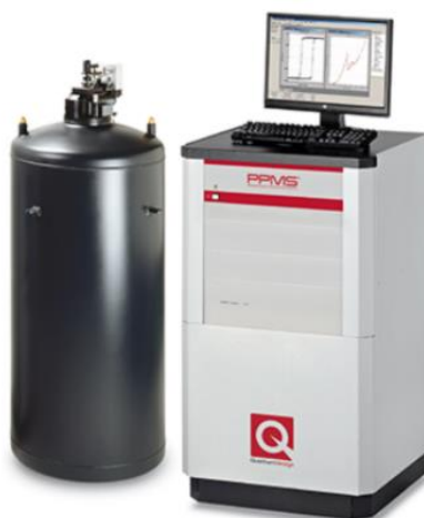
Figura 15: Sistema de Medição de Propriedades Físicas (PPMS) modelo DynaCool da Quantum Design equipado com uma bobina supercondutora que produz campos magnéticos de - 90 kOe até + 90 kOe.
