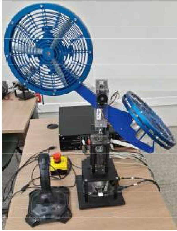
Figura 78 – Sistema dinâmico não linear multivariável composto de helicóptero de 2 graus de liberdade. Fonte: Rocha Filho (2017).
