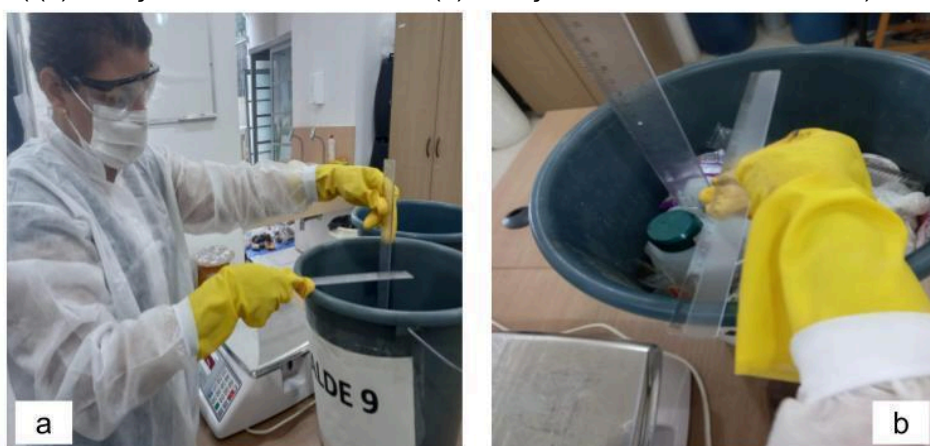
Figura 6 - Etapas da caracterização volumétrica (a) medição do volume do balde, (b) medição do volume dos resíduos)
