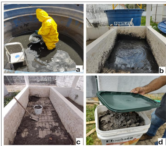
Figura 13 - (a) Coleta do LETE no Tanque Adensador; (b) Despejo do LETE no leito de secagem; (c) LETE seco; (d) Armazenamento LETE
