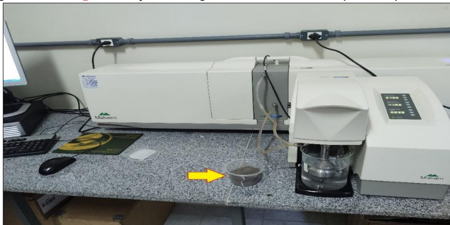
Figura 14 - Aparelho Malvern Mastersize 2000 com a amostra de LETE sinalizada com a seta amarela. Programa de Pós-Graduação de Engenharia dos Materiais (PPGEM) - IFMA Monte Castelo
