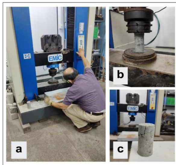
Figura 16 - Rompimento dos corpos de prova cilíndricos
