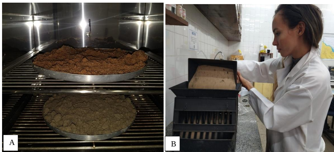
Figura 5 - (A) Secagem das amostras (B) Processo de quarteamento
