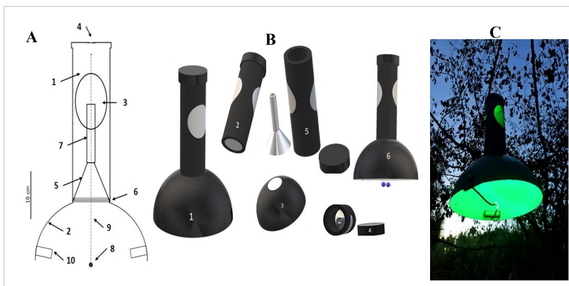
Figura 18. Armadilha Silva. (A) Desenho da armadilha Silva; (B) Partes separadas da armadilha; (C) Armadilha em campo.
