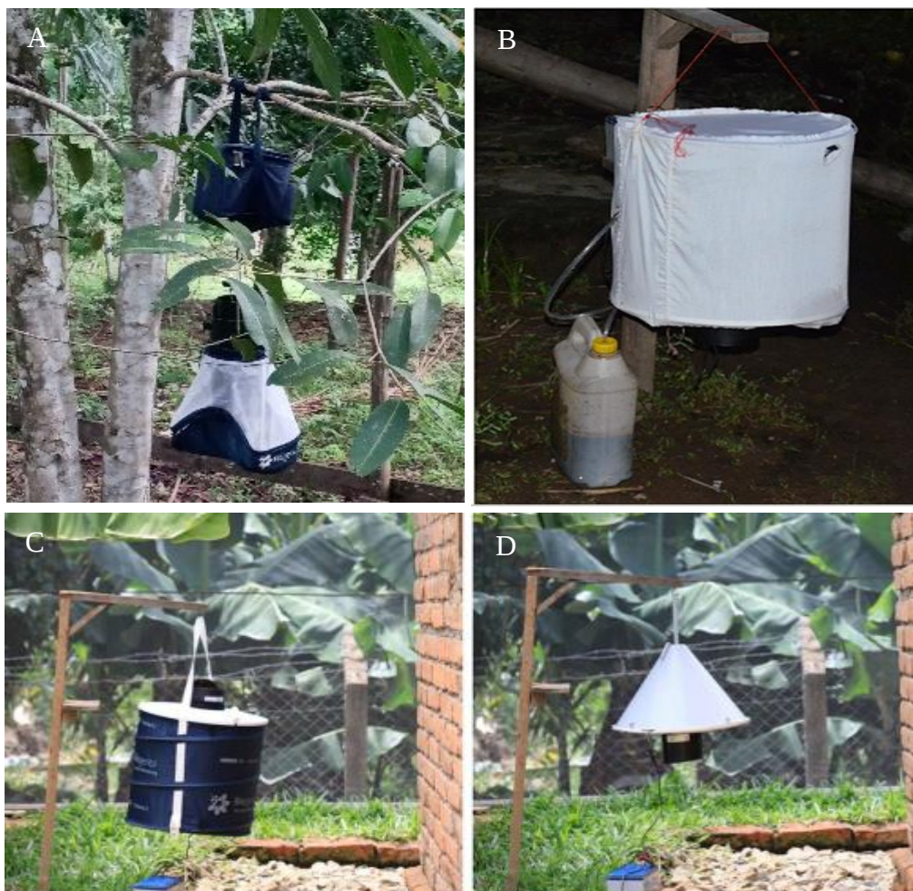
Figura 16. Armadilhas que utilizam atrativos químicos na captura de espécies de Anopheles . Armadilhas que são combinadas com atrativos para atração e captura de espécies de vetores da malária, (A) BG-Pro, (B) BG-Malaria, (C) BG-Sentinel, (D) BG-Suna. Fonte: COSTA-NETA, BM, 2022; GAMA et al., 2013; MWANGA et al., 2019.
