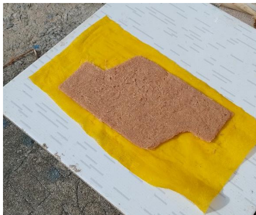
Figura 22: Secagem em temperatura ambiente nos testes de produção do revestimento.
