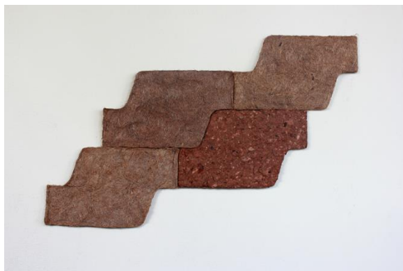
Figura 14: Protótipos iniciais do revestimento em fibra de bananeira e papel reciclado.
