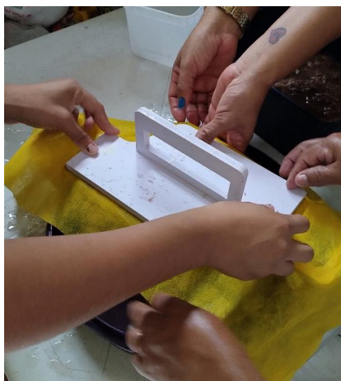
Figura 26: Segundo teste de produção de revestimento em fibra de bananeira.
