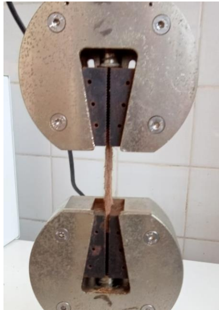
Figura 33: Fixação do corpo de prova na máquina.
