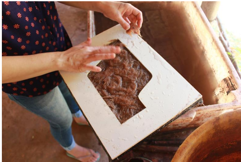
Figura 16: Prototipagem inicial de revestimento composto de fibra de bananeira.
