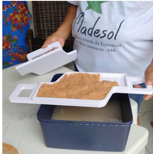
Figura 20: Fibra de bananeira depositada em molde para produção artesanal de revestimento.
