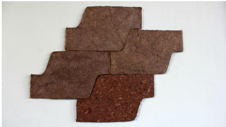
Figura 15: Protótipos iniciais do revestimento composto de fibra de bananeira.
