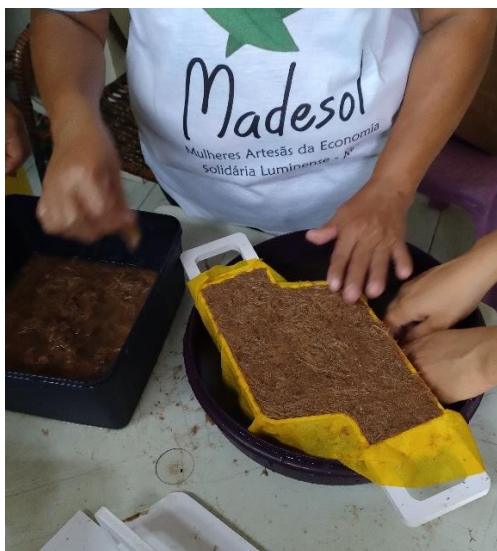
Figura 25: Segundo teste de produção de revestimento em fibra de bananeira.
