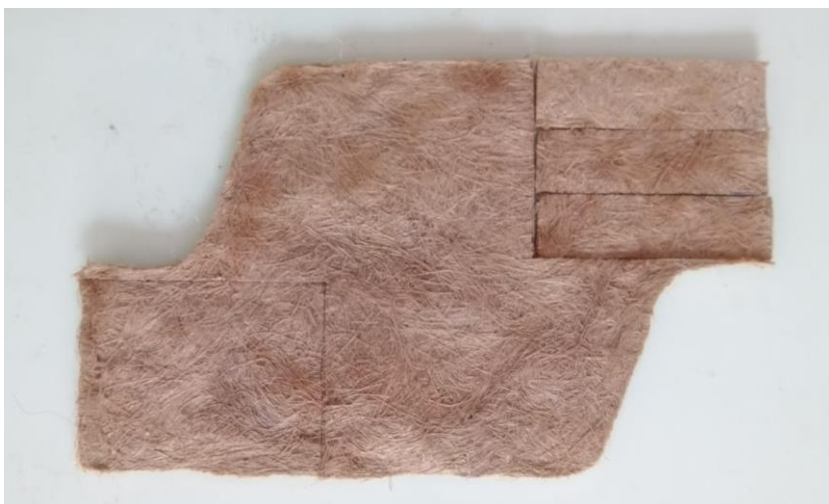
Figura 32: A) Posicionamento do corte dos corpos de prova nos revestimentos.
