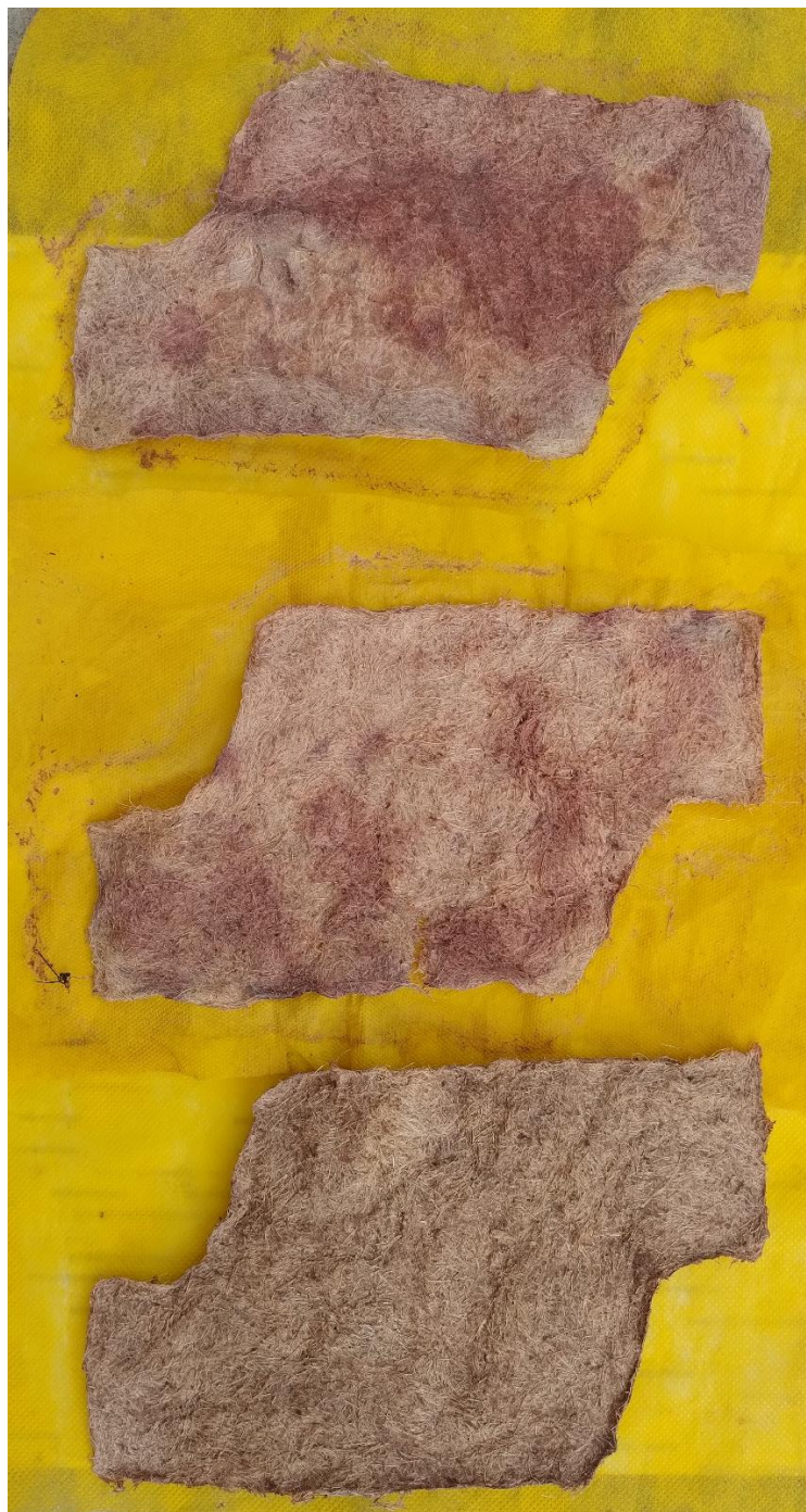
Figura 27: Peças resultantes do primeiro teste de produção de revestimento após secagem.
