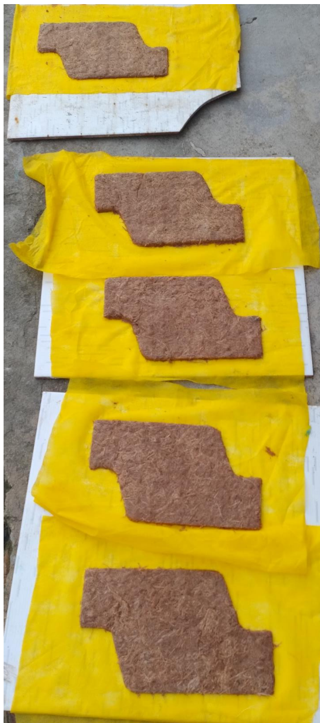
Figura 24: Peças resultantes do segundo teste de produção de revestimento em fibra de bananeira.
