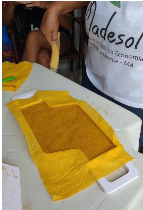
Figura 21: Adaptação ao processo de produção artesanal do revestimento em fibra de bananeira.
