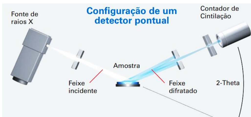
Figura 24 – Configuração de um detector pontual com geometria Bragg Brentano.
