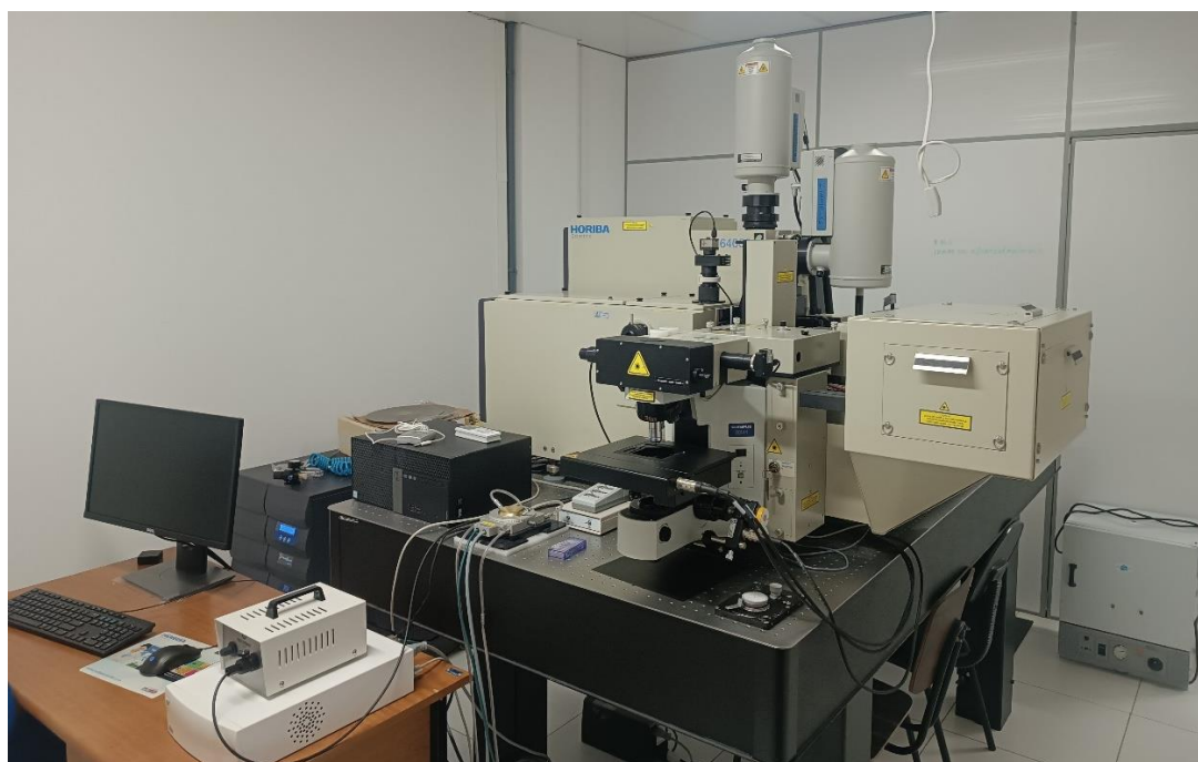
Figura 5 – Espectrômetro Raman T64000 da Horiba com microscópio BX41M da Olympus acoplado.
