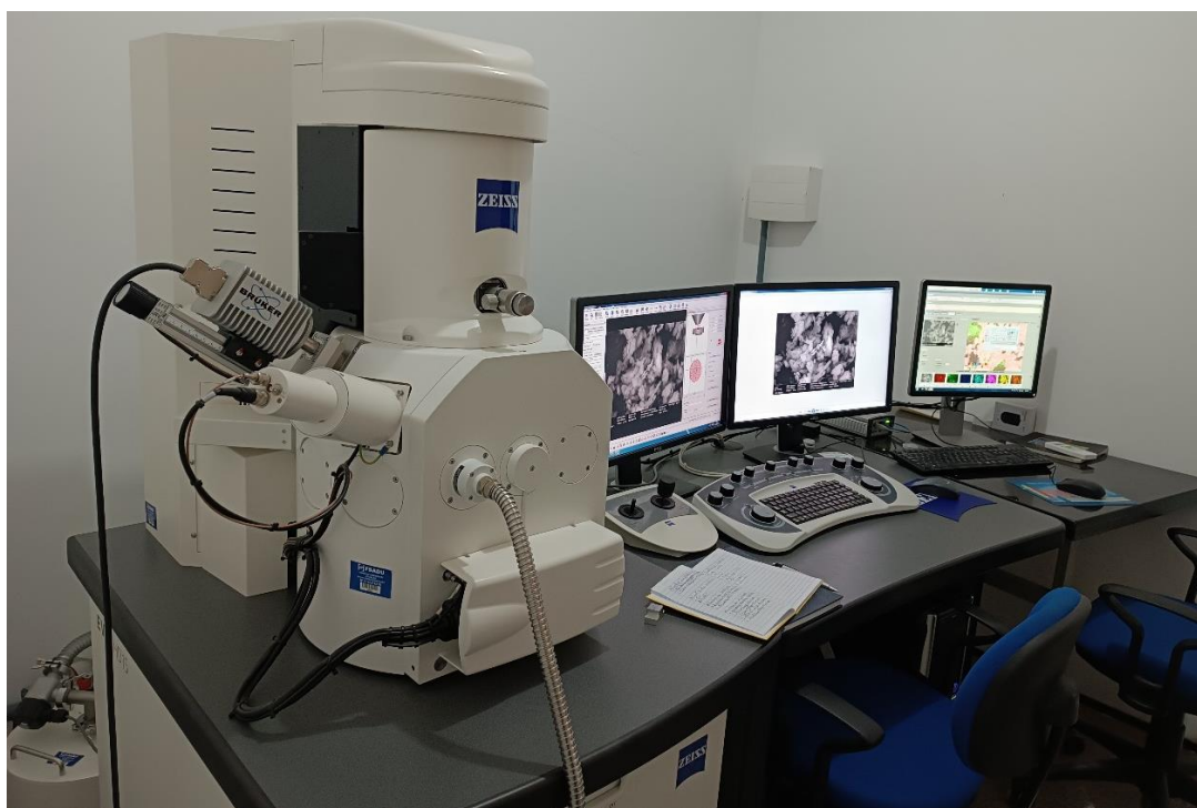
Figura 7 – Microscópio Eletrônico de Varredura da Zeiss modelo EVO HD15 usado para a caracterização da morfologia dos cristais de \text{NaGd}(\text{MoO}_4)_2 com detector de elétrons secundários.
