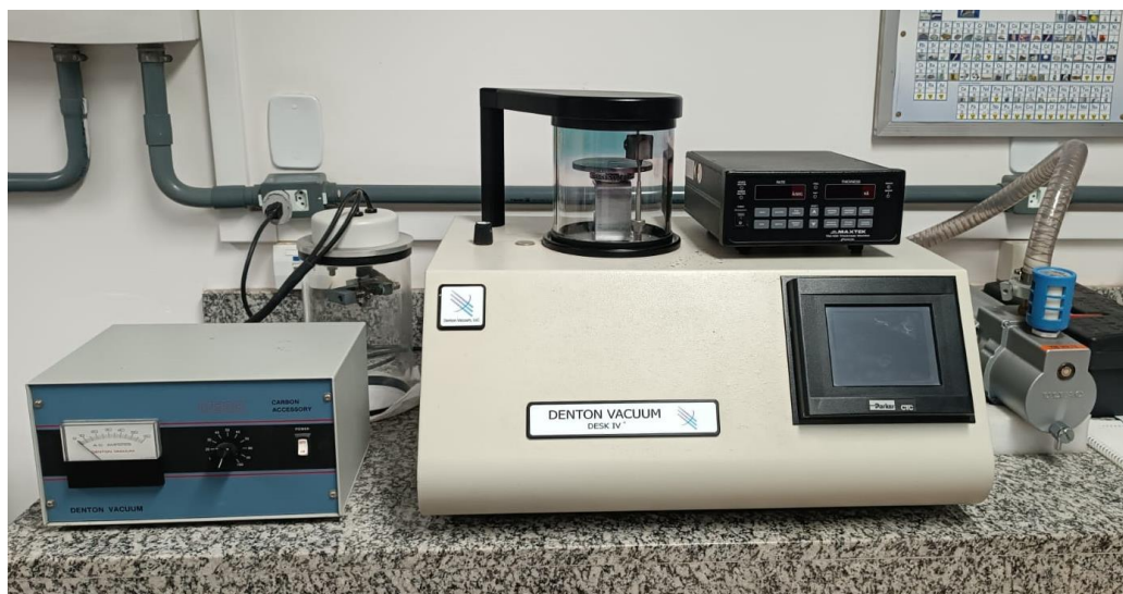
Figura 8 – Metalizadora ( Denton Vacuum Sputter Coater ) utilizada no experimento de pulverização das amostras de \text{NaGd}(\text{MoO}_4)_2 .
