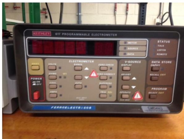
Figura 19: Eletrômetro utilizado na realização das medidas piroelétrica
