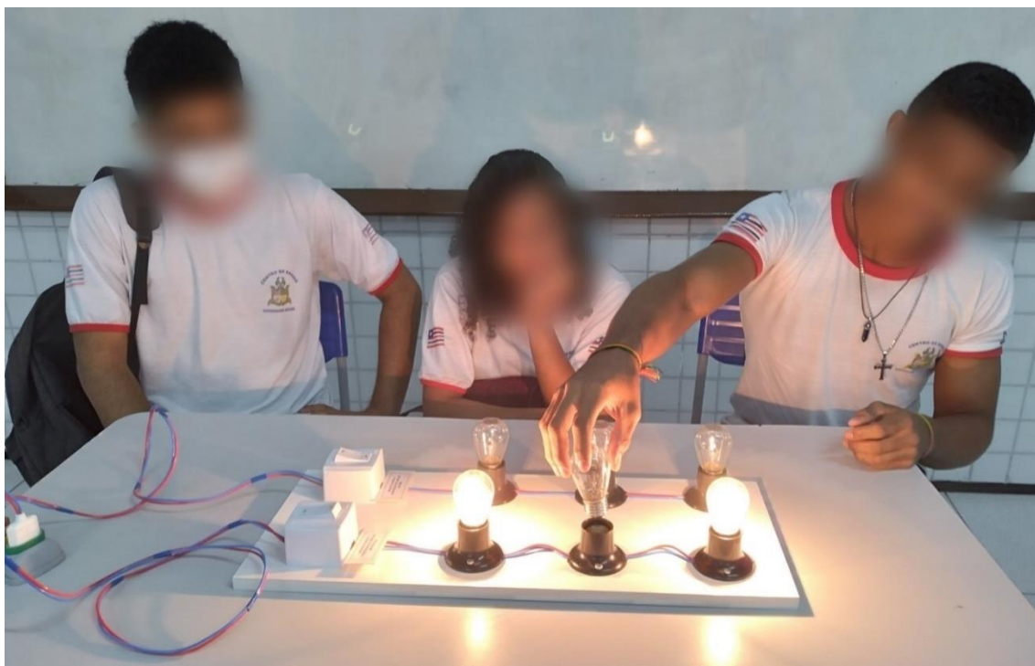
Figura 75 – Retirada de uma das lâmpadas na associação em paralelo
