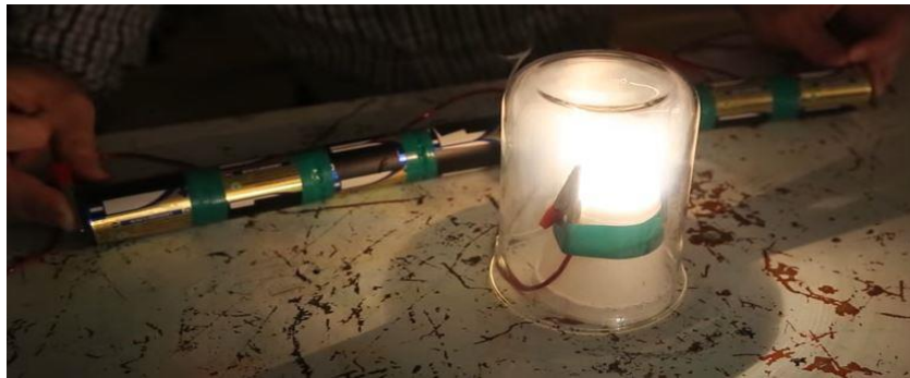
Figura 11 – Terceiro estágio da lâmpada caseira (brilho intenso)
