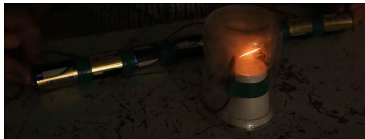
Figura 9 – Primeiro estágio da lâmpada caseira (pouco brilho)
