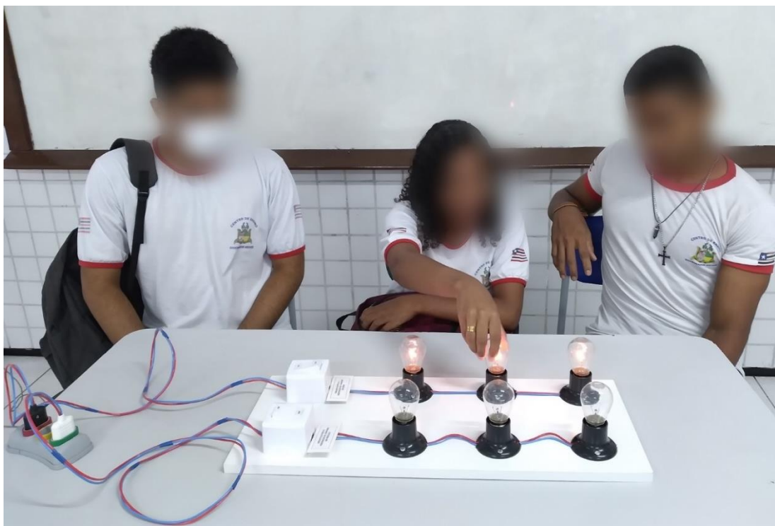
Figura 74 – Retirada de uma das lâmpadas na associação em série
