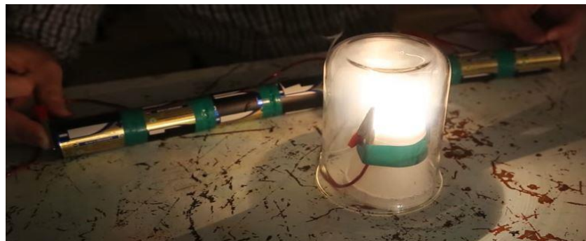
Figura 31 – Terceiro estágio da lâmpada caseira (brilho intenso)
