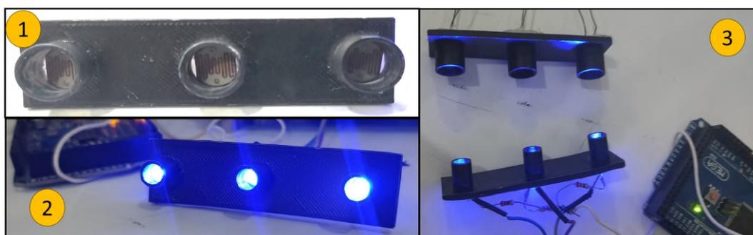
Figura C.2: Prototipação do estudo do sensor para detecção de partículas de poluentes. 1) estrutura de recepção da luz azul com LDRs, 2) estrutura do emissor, 3) estrutura completa de emissão e recepção.
