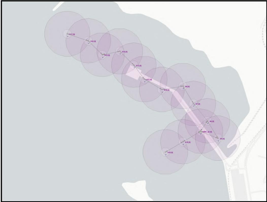
Figura A.5: Projeto da rede de sensores sem fio proposta para cobertura dos berços de atracação 105, 106 e 108.
