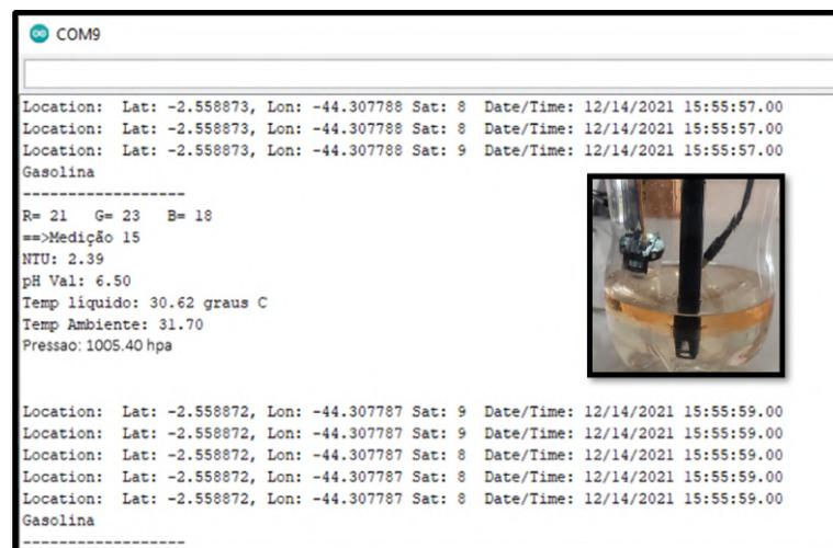
Figura 5.13: Medição com nó sensor e classificação da Gasolina.
