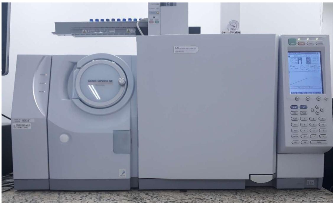
**Figura 10** - Cromatógrafo gasoso acoplada a espectrômetro de massa – CG-EM - QP2010SE (Shimadzu).
