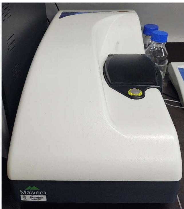
**Figura 12** - Equipamento Zetasizer Nano® S90 (Malvern Instruments®) para determinação do tamanho médio e o índice de polidispersividade (PDI).
