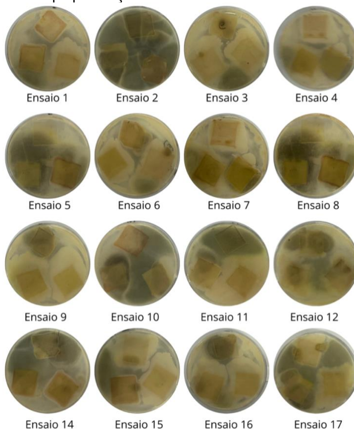
Figura 6. Análise do potencial antifúngico na inibição de Curvularia de filmes poliméricos incorporados com óleo de polpa de açaí
