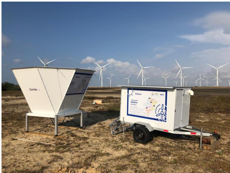
Figura 5 – SODAR em campanha de medição na região de estudo. O reboque sobre rodas refere-se ao sistema de comunicação remota e potência, alimentado por painéis solares.
