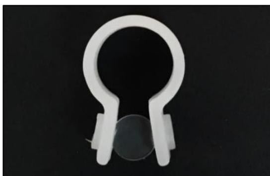
**Figura 35.** Visualização da fixação em suporte de polipropileno de uma amostra fatiada, de 10 mm de diâmetro, preparada para teste de bioatividade. **Fonte:** Acervo próprio.
