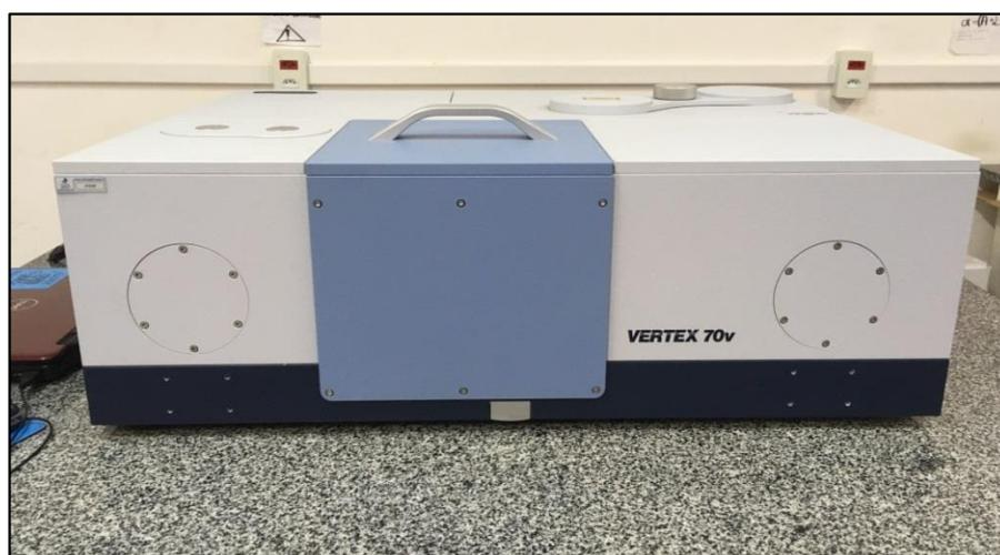
**Figura 23.** Espectrômetro FTIR (Modelo *Vertex 70V*, da marca *BRUKER*) utilizado na análise vibracional das amostras sintetizadas. **Fonte:** Acervo próprio.
