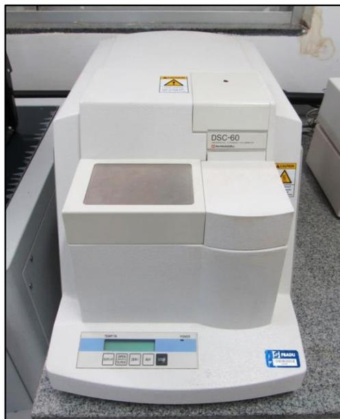
**Figura 24.** Analisador térmico com detecção por fluxo de calor (Modelo *DSC-60*, da marca *SHIMADZU*).
