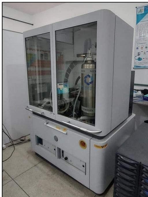
**Figura 22.** Difratorômetro (Modelo *Empyrean*, da marca *PANalytical*) utilizado na obtenção dos difratogramas DRX das amostras sintetizadas. **Fonte:** Acervo próprio.
