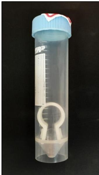
**Figura 36.** Representação de uma amostra fixada em suporte de polipropileno inserida em um tubo de Falcon na posição vertical. **Fonte:** Acervo próprio.
