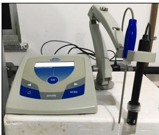
**Figura 26.** pHmetro microprocessado de bancada utilizado para as leituras de potencial hidrogeniônico (Modelo PG1800, da marca *GEHAKA*). **Fonte:** Acervo próprio.
