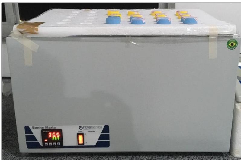
**Figura 25.** Tubos de Falcon imersos em banho-maria com temperatura ajustada a 36,5 °C (Modelo N1030T, da marca NOVATECNICA) contendo amostras imersas em 25 ml de solução SBF. **Fonte:** Acervo próprio.
