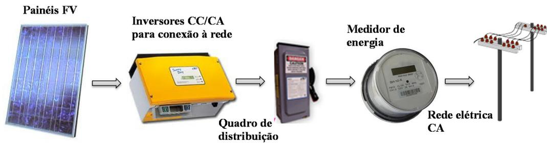
Figura 1.4 – Componentes de um sistema FV conectado à rede elétrica.
