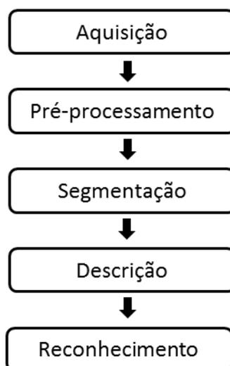
**Figura 9 - Passos fundamentais para o processamento de imagens**
