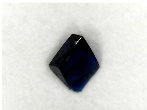
**Figura 21.** Monocristal Cu(Fen)(Asn) obtido por evaporação lenta do solvente.
