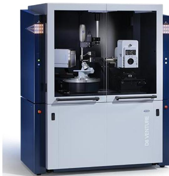
**Figura 23.** Difratômetro D8 Venture da Bruker.
