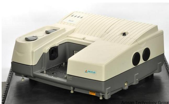
**Figura 24.** Espectrômetro Nexus 470 da Nicolet.
