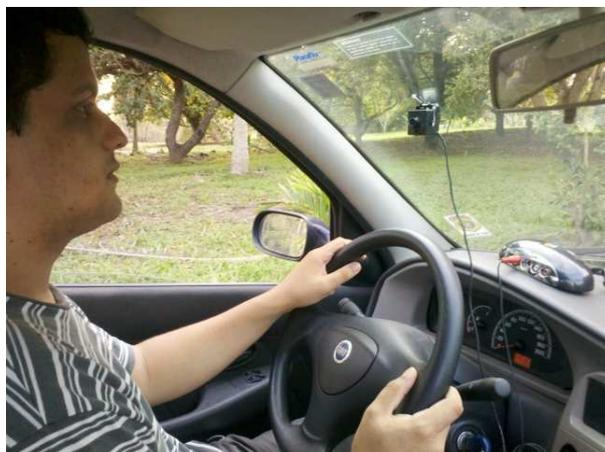
Figura 3.4: Disposição da câmera no interior do veículo.
