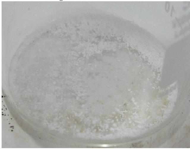
Quando a chapa aquecedora registrou 130 °C, o OXA se apresentava da mesma forma como exposta pela Figura 7. Sabendo que em aproximadamente 140 °C o OXA começa a sublimar, aumentou a temperatura da chapa aquecedora para 160 °C, afim de acelerar o processo de sublimação do OXA. Verificou-se que o OXA ressublimou na forma de pequenos cristais translúcidos em formato de agulhas. A Figura 8 mostra o OXA sublimado e a Figura 9 o OXA ressublimado.
