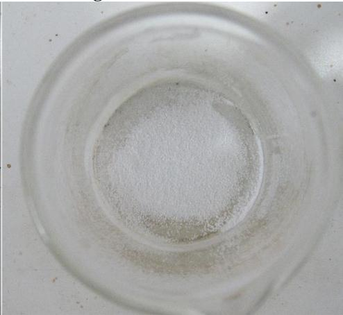
Na sequência realizou-se o experimento para o OXA, a Figura 4 contém o OXA no início do procedimento. Observou-se em aproximadamente 60 °C a condensação da água no vidro de relógio, proveniente da desidratação do OXA, assim como mostrado na Figura 5.
