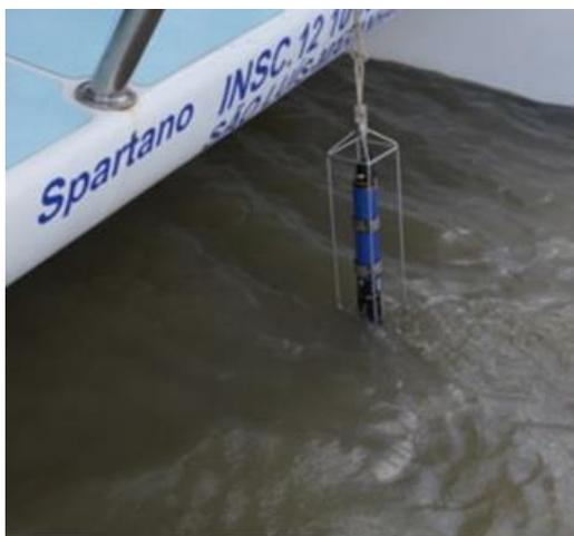
**Figura 4.** CTD (EXO2/YSI), com grade de proteção. Fonte: Santos (2018b).
