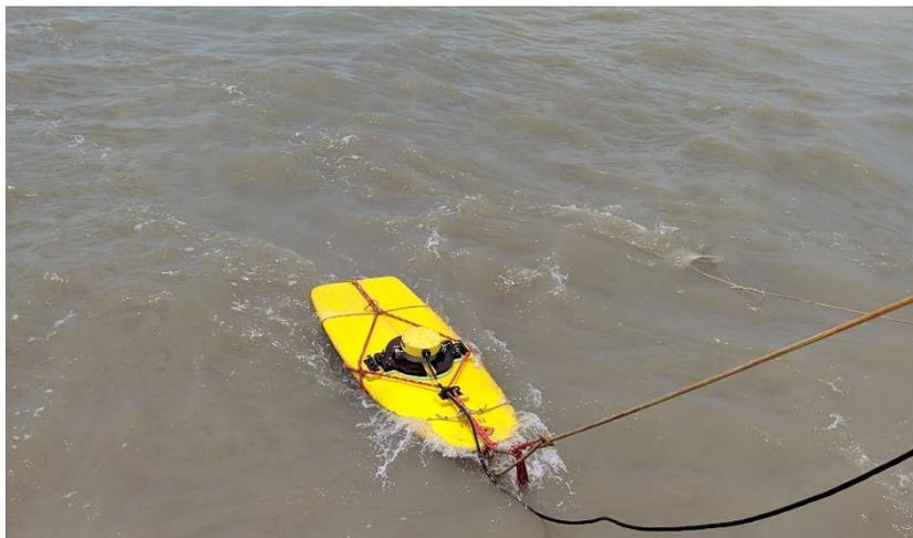
**Figura 3.** ADCP acoplado à prancha, rebocado na popa da embarcação. Fonte: Autora (2020).
