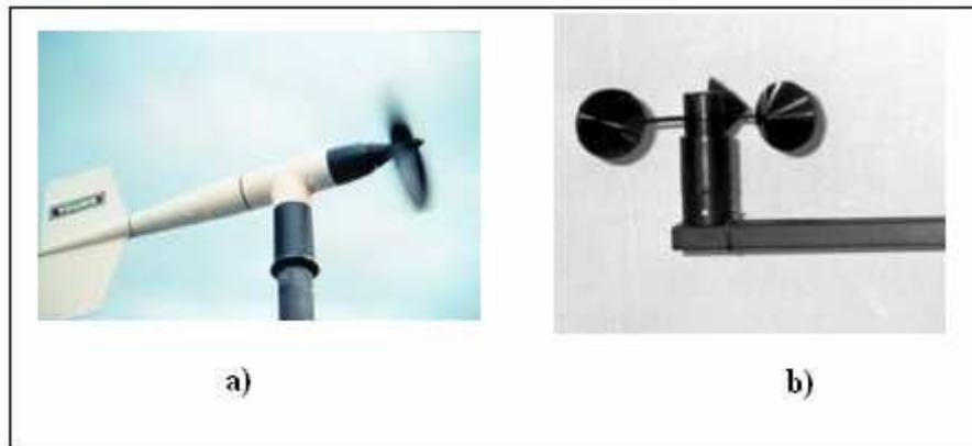
Figura 6. Ilustração de um anemômetro do tipo rotacional: a) usando hélices e b) tipo canecas semi-cônicas.
