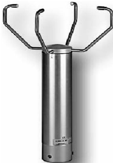
Figura 11. Ilustração de um modelo de anemômetro ultra-sônico, fabricado pela Thies.
