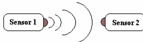
Figura 4. Ilustração da transmissão ultra-sônica em modo pulsado ou contínuo com compensação de temperatura.
