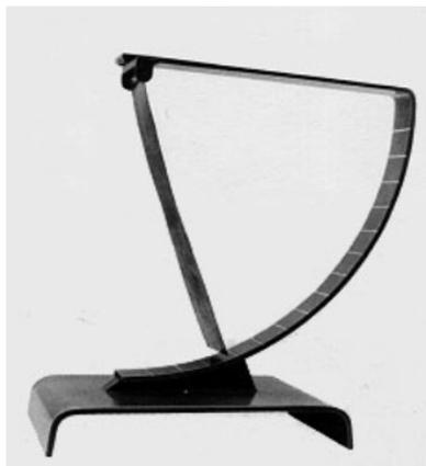
Figura 8. Ilustração do anemômetro de Deflexão.
