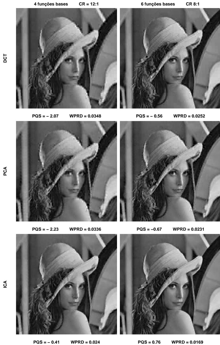
Figure 5.7: Imagens da Lena, quantizadas a cinco *bits* e reconstruídas a partir DCT, PCA e ICA, com seus respectivos valores do PQS e WPRD sendo na primeira coluna utilizadas 4 funções base e na segunda 6 funções base.
